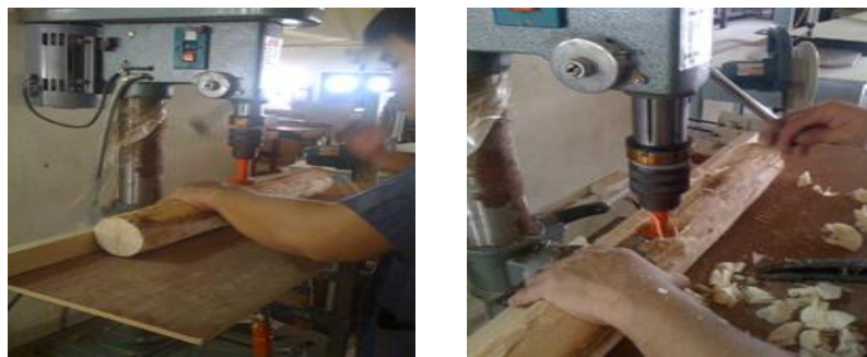
ภาพที่ 3. การเจาะรูเดือยไม้ท่อนยูคาลิปตัส
